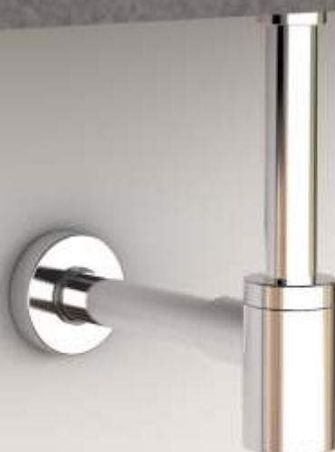
"MIGNON" sifone d'arredo in acciaio inossidabile ad altezza ridotta. Lunghezza canotti: ingresso 170 mm, uscita 300 mm
