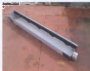
Canaletta di sfiro in acciaio inox a profilo Thompson con paraschiama.
