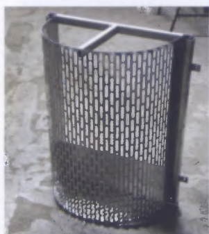
Griglia a cestello ad estrazione manuale in acciaio inox con guide per l'estrazione
