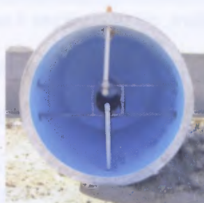
Sedimentatore su monoblocco prefabbricato di c.a.v. circolare verticale completi di apparecchiature per il trasferimento dei fanghi air-lift o elettrici, deflettore di calma, canaletta di sfiro. I sedimentatori possono essere impermeabilizzati internamente con materiale resistente alla corrosione delle acque reflue.
