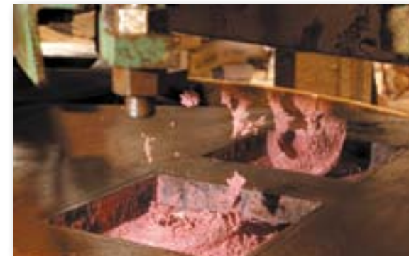
1. Versamento dell'impasto/Batch out mixture
