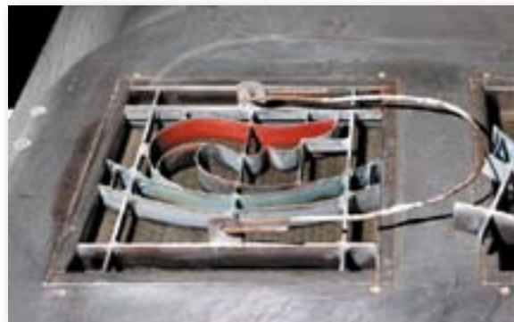
1. Divisionale nello stampo/Slide divider into mould
