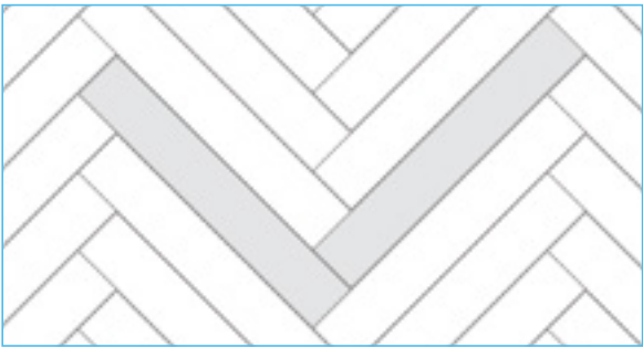
Colocación en espiga
