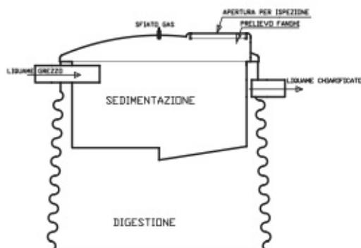
Le fosse imhoff **MAPOL**, realizzate in polietilene, sono leggere, resistenti alle pressioni dell'interramento, facili da trasportare e da installare. Progettate secondo le normative vigenti, sono formate da due comparti separati che montati assieme formano un unico corpo.
