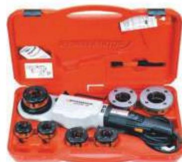
Comprende SUPERTRONIC 2000 con morsetto forgiato, adattatore ROFIX, testine, completo in cassetta di plastica portatile
