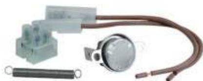
Microtermostato a contatto N.A., temperatura di intervento a  $42^{\circ}\text{C} \pm 3.5^{\circ}\text{C}$  e ripristino a  $31^{\circ}\text{C}$ . Completo di cavetto 200 mm con faston e morsetti di collegamento.
