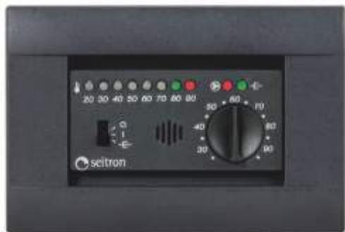
Centralina da incasso a 3 moduli per caminetti con caldaia. Impostazione della temperatura dell'acqua tramite manopola. Indicazione a barra di LED della temperatura dell'acqua. Allarme acustico a superamento di 90°C. Uscite per comandare una pompa di circolazione e un grill.
