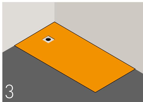
Applicare uno strato sufficiente di isolante sul fondo e alle pareti per evitare infiltrazioni d'acqua.
