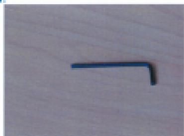
CHIAVE A BRUGOLA DA 3 MM DA UTILIZZARE PER SVITARE LA VITE CHE FERMA LA LEVA
